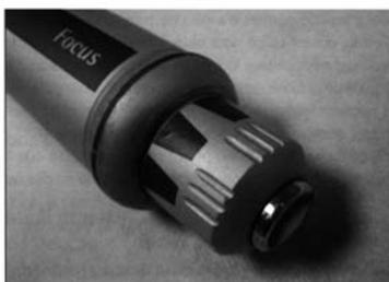
**Il existe deux têtes de sonde différentes** : une sonde classique à extrémité convexe qui va permettre une divergence des ondes et une sonde focalisée concave où les ondes vont être focalisées.
